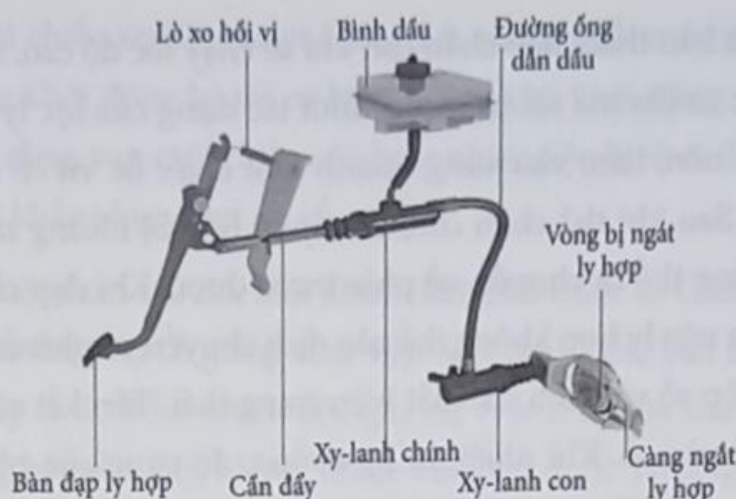
Hình 1 - Thành phần của cơ cấu điều khiển ngắt ly hợp thủy lực
